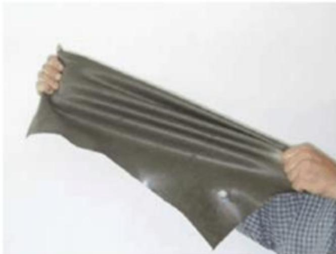
ACRILET 198 не является материалом подобным резиновой краске - это плотная мастика, которая после высыхания образует покрытие с характеристиками подобными линолеуму: прочное на растяжение, гибкое на изгиб, полная водонепроницаемость, прочность к истираемости.
